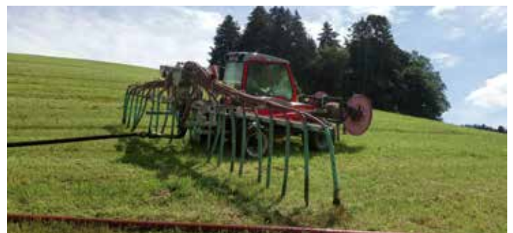
Mit dem Schleppschauch wird unsere Gülle ausgebracht, dies vermindert die Ammoniakemissionen und bringt die Gülle direkt zu den Pflanzen, damit diese die Nährstoffe so rasch als möglich aufnehmen können.
